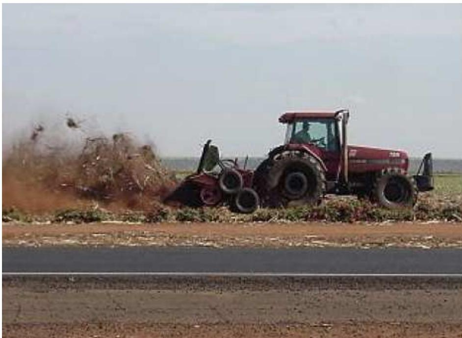
Figura 4 – Eliminador mecânico em operação em área atacada.
